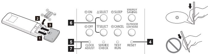
1~3. Coloque las baterías tal y como se muestra en la figura de arriba.
