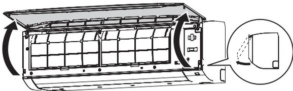
3. Abra la cubierta del adaptador de la WLAN hasta oír un chasquido.
