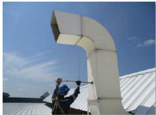
FGA (THAILAND) CO., LTD.における 排気ダクトの大気質サンプル採取の様子
