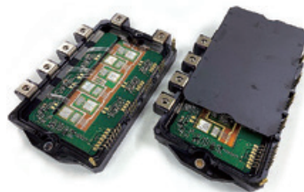
エレクトロニクス製品の小型化・高効率化に寄与する「パワーモジュール」
