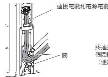
將連接電纜和電源電纜拉到室外機組後面的 2 個閂門之間，如圖如示。
