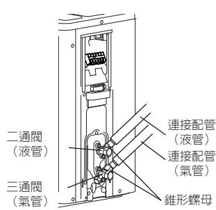
(4) 在用手將錐形螺母擰緊後，使用扭矩扳手做完全擰緊的動作。
