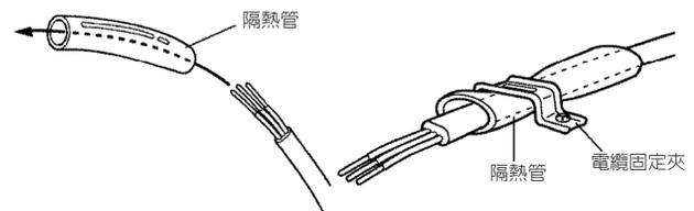
請使用 VW-1、1.0 mm 厚的 PVC 管作為隔熱管。
