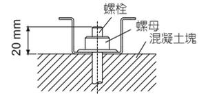
用螺栓確實地固定在混凝土塊上。(使用 4 套市售 M10 螺栓、螺母和墊片。)
