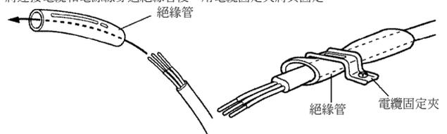
絕緣管請使用 VW-1、厚度為 1.0mm 的 PVC 管。
